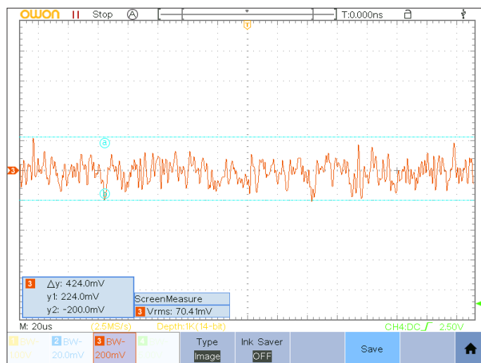
Bild A6: Rauschen eines 10-k \Omega -Widerstands am Eingang des Tastkopfs, gemessen bei f_U = 0,3 \text{ Hz} , f_O = 300 \text{ kHz} und V_U = 10000
