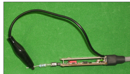
Bild A2: Tastkopf in Seitenansicht; durch den Schrumpfschlauch mit Schmelzkleber liegt das Kabel nun fest.
