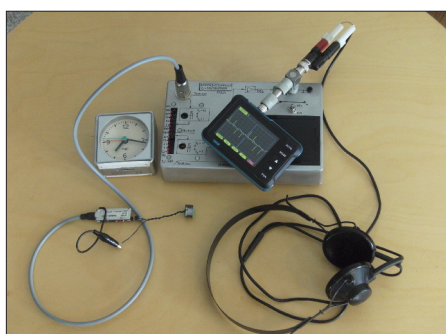
Bild A14: Mobiler Aufbau mit H-Feld-Sonde am Tastkopfeingang; ein 2-kΩ-Funkerkopfhörer und das Mini-Oszilloskop DSO-200 sind parallel am Ausgang des Bandpassverstärkers angeschlossen.
