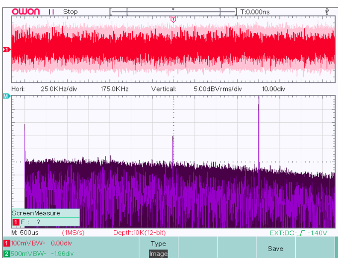
Bild A9: Die untere Bildhälfte zeigt das Rauschspektrum eines 10-k \Omega -Widerstandes bei f_U = 1 \text{ Hz} , f_o = 300 \text{ kHz} und V_U = 10\,000 . Die Vertikalempfindlichkeit ist auf 5 dB/Div. eingestellt.
