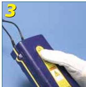
3 Druk de schakelaar van de besturingseenheid in en houdt deze ingedrukt totdat de ontsteking plaatsvindt
